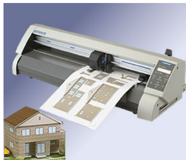
図 2.5: カッティングプロッタを用いた展開図の切り出し (グラフィック株式会社 [16])
