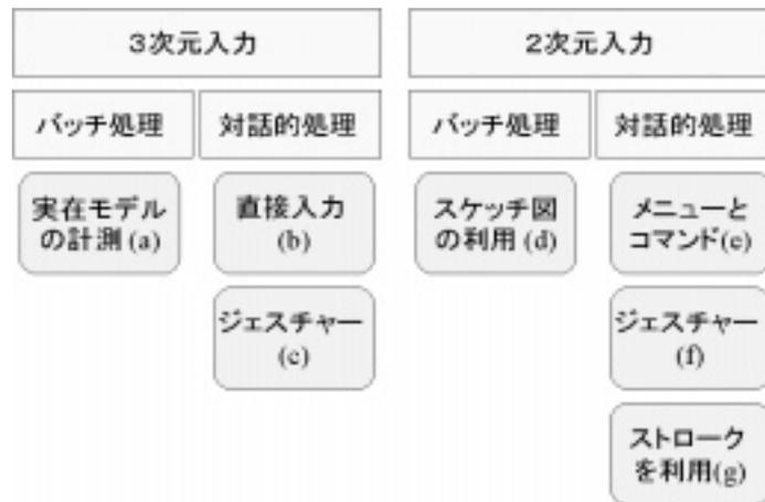
図 2.1: 入力形態による3次元形状モデリング手法の分類
